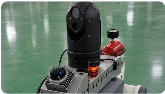
上装特写 双光云台 · 小型灭火装置 · 声光报警
